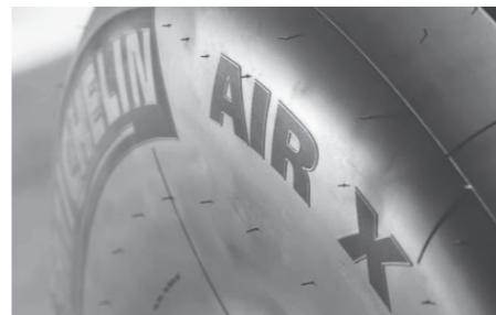
ミシュランの航空機用ラジアルタイヤ [MICHELIN Air X®] 提供：日本ミシュランタイヤ株式会社
